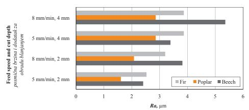
Figure 6 Ra – arithmetic mean value of profile deviation shown as comparison for fir, poplar and beech and given parameters Slika 6. Usporedni prikaz aritmetičke srednje vrijednosti odstupanja profila (Ra) za jelovinu, topolovinu i bukovinu te za zadane parametre
