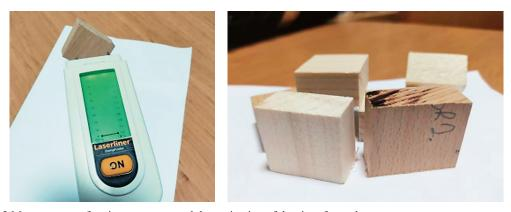
**Figure 3** Measurement of moisture content and determination of density of samples **Slika 3.** Mjerenje sadržaja vode i određivanje gustoće uzoraka
