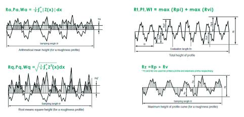
**Figure 1** Graphics of roughness parameters evaluated included *Ra*, *Rq*, *Rt*, and *Rz* (Nicolas-Silvente *et al.*, 2020) **Slika 1.** Grafički prikaz istraživanih parametara hrapavosti *Ra*, *Rq*, *Rt* i *Rz* (Nicolas-Silvente *et al.*, 2020.)
