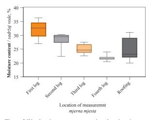
Figure 3 Wood moisture content at various locations in water mill (n = 10) Slika 3. Sadržaj vode u drvu na različitim mjestima u vodenome mlinu (n = 10)
