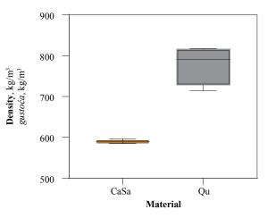
**Figure 7** Density of mill sweet chestnut (CaSa) and oak (Qu) wood determined in laboratory (n = 5) **Slika 7.** Laboratorijski određena gustoća drva pitomog kestena (CaSa) i drva hrasta (Qu) od kojih je mlin izgrađen (n = 5)
