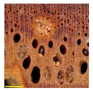
**Figure 9** Insect hole in sweet chestnut wood filled with debris typical for beetles from genus *Anobium* **Slika 9.** Rupe od kukaca u drvu pitomog kestena ispunjene ostatcima tipičnima za kornjaše iz roda *Anobium*
