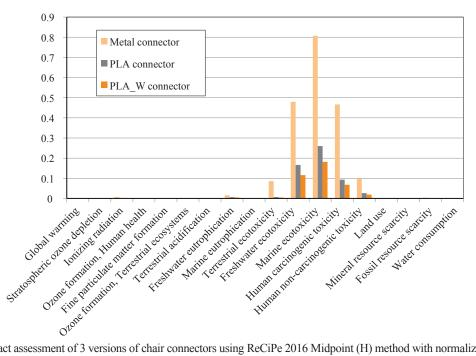
Figure 3 Impact assessment of 3 versions of chair connectors using ReCiPe 2016 Midpoint (H) method with normalization of results Slika 3. Procjena utjecaja na okoliš triju verzija poveznika za stolicu primjenom metode ReCiPe 2016 Midpoint (H) s normalizacijom rezultata
