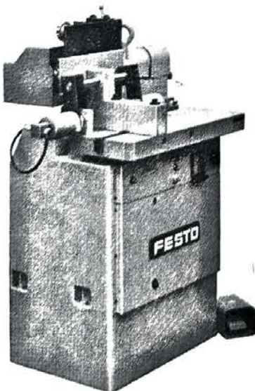
Slika 12.: FESTO-va glodalica za klinasti spoj FKV
