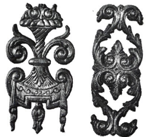
Reljefni ukrasi izrađeni prešom za utiskivanje.
