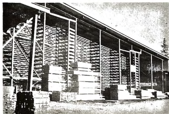
Slika 10. Mnogoetažna, kratka, automatska sortirnica piljenica. Pilana u Branscombu, California
