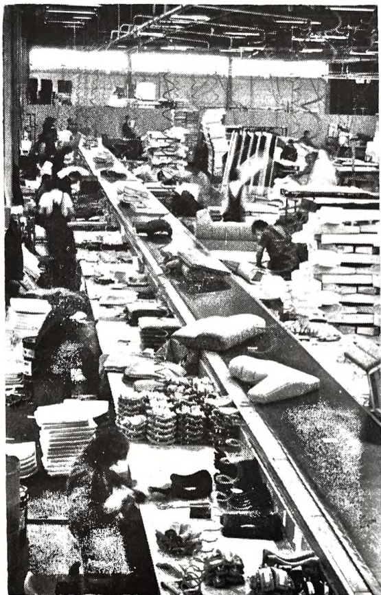
Odjel tapetarije — linija za izradu stranica za višesjede, te rukonaslona i fotelja
