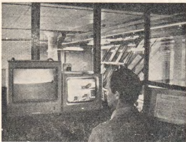
Slika 3. Kontrolni punkt podataka o kvaliteti. Snimak trupca emitira se na TV ekranu
