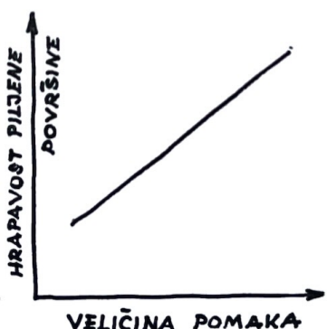
Sl. 11. — Odnos između veličine pomaka po okretaju kod jarmače i piljenice (veličine neravnosti) piljene površine
