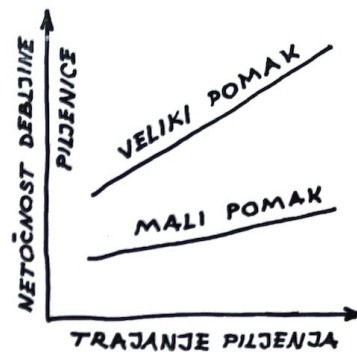
Sl. 9. — Odnos između trajanja piljenja (zatupljenosti zubaca), tačnosti (varijacije) debljine piljenice te većeg i manjeg pomaka po jednom okretaju kod jarmača
