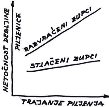
Sl. 7. — Odnos između trajanja piljenja (zatupljenosti zubaca) na jarmači, tačnosti (varijacije) debljine piljenice te pila s razvraćenim i stlačenim zupcima
