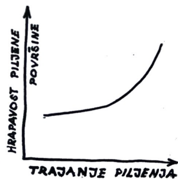
Sl. 12. — Odnos između trajanja piljenja (zatupljenosti zubaca) na jarmači i hrpavosti piljene površine
