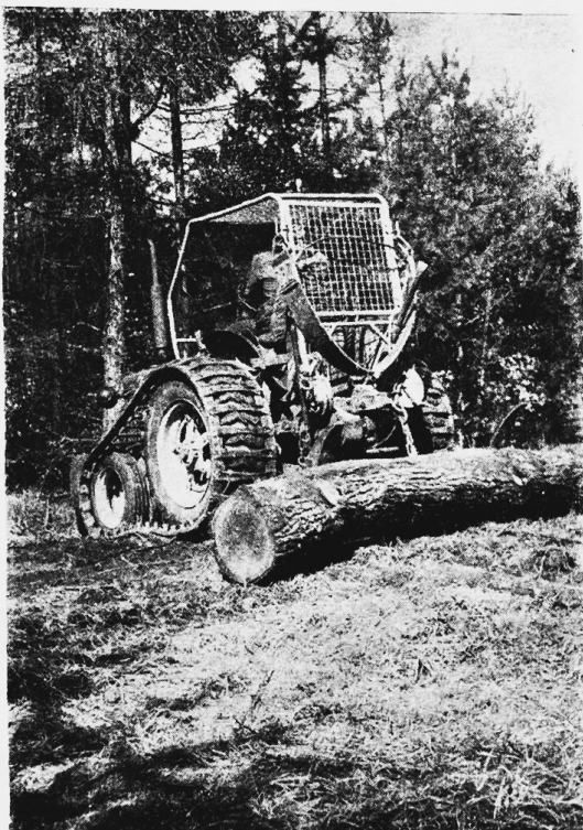
Sl. 2. Traktor Zetor 25 sa polugusjenicama (VULH, stanica Krtiny)
