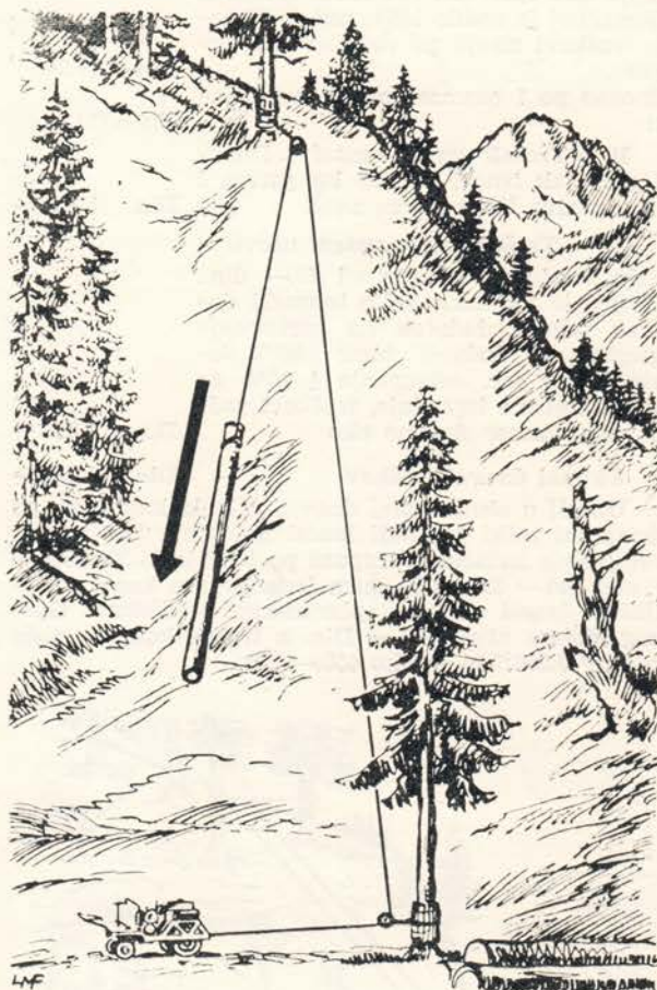
Sl. 6. Spuštanje trupaca po tlu nizbrdo motornim vitlom »Bergkuli«
