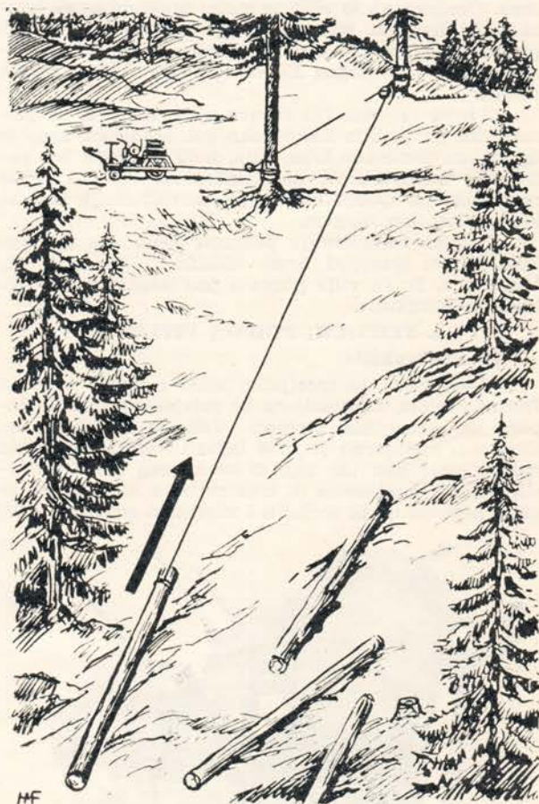
Sl. 4. Jednostavna vuča trupaca uzbrdo po tlu motornim vitlom »Bergkuli«
