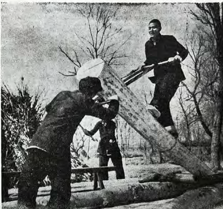
Uvođenje mehanizacije potiskuje ovaj zastarjeli način piljenja trupaca
