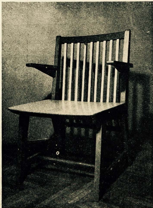
Slika 1 i 1a — Polufotelj s tvrdim sjedalom i ručnim naslonima te naslonima iz vertikalnih šprljaka. Svi su dijelovi lako obradivi na stroju, a sastavi su jednostavni. Jednostavnost oblika i konstrukcije omogućava laku strojnu obradu
