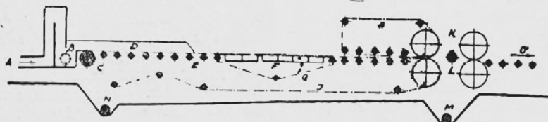
Slika 1. — Šematski prikaz Fourdrinier stroja
