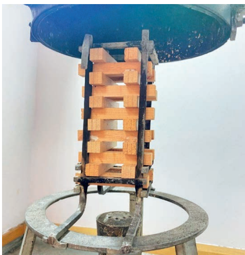
Figure 2 Test samples and combustion test Slika 2. Ispitni uzorci i test gorivosti
