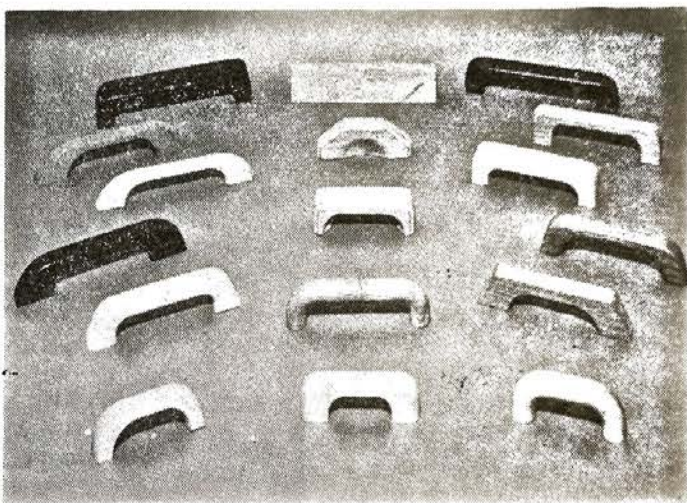
Kopirna glodalica — karusel za obradu prihvatnih ručki F0 500-2 Fi, i uzorci obrađenih ručki, KNOEVENAGEL SR Njemačka
