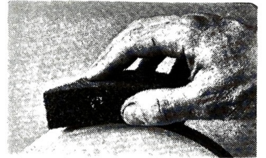
Podložak za ručno brušenje izrađen od spužve obložene abrazivom, koja se prilagođuje svim oblicima
