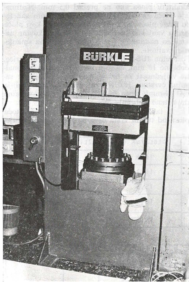
Slika 2. Laboratorijska preša za proizvodnju iverica Fig. 2. Laboratory press for chipboard production
