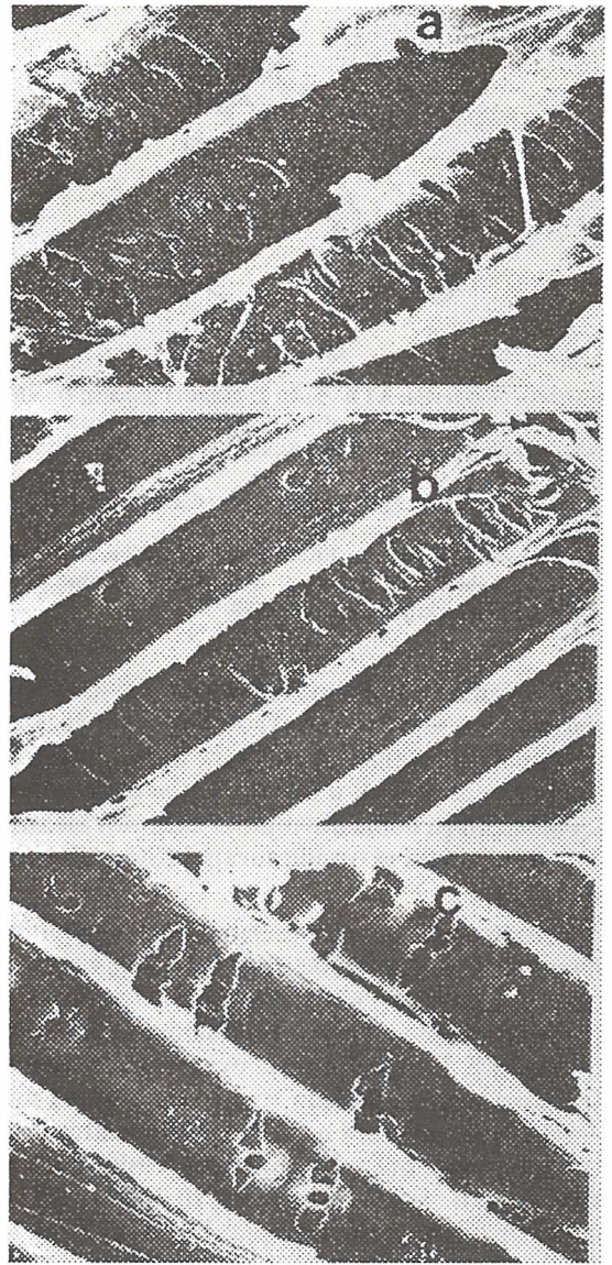
Slika 3. Oštećenja uzrokovana djelovanjem "pukotinastih bakterija" (Cavitation bacteria). a) i b) Pukotine na stijenkama traheida ranog drva. c) Proširene skupine pukotina na ogradenim jažicama traheida ranog drva. Pretisak iz: Nilsson, T., Cavitation bacteria, The International Research Group on Wood Preservation, Doc. No: IRG/WP/1235, 1984.
