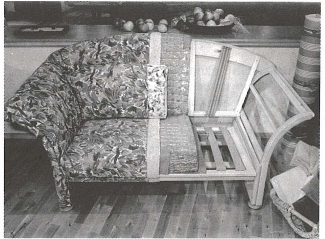
Slika 2. Ražena slama kao materijal za izradu madraca već je dokazano prikladan materijal. Na ovogodišnjem je sajmu prezentirana i na ostalim vrstama tapeciranoga (ojastučenog) namještaja.
