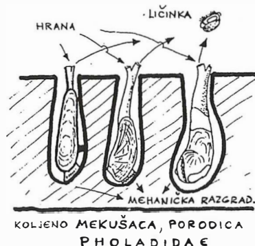
Slika 2. Shematski prikaz života i načina razgradnje drva djelovanjem mekušaca iz porodice Pholadida (školjakašica) Fig. 2. Schematic review presentation of life and method of destroying wood by Mollusca from the Pholadidae family
