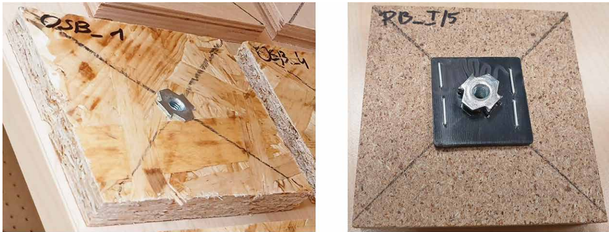
a) b) Figure 4 Examples of test samples: a) OSB, b) particleboard with a rubber pad Slika 4. Primjeri ispitnih uzoraka: a) OSB, b) iverica s gumenim podloškom
