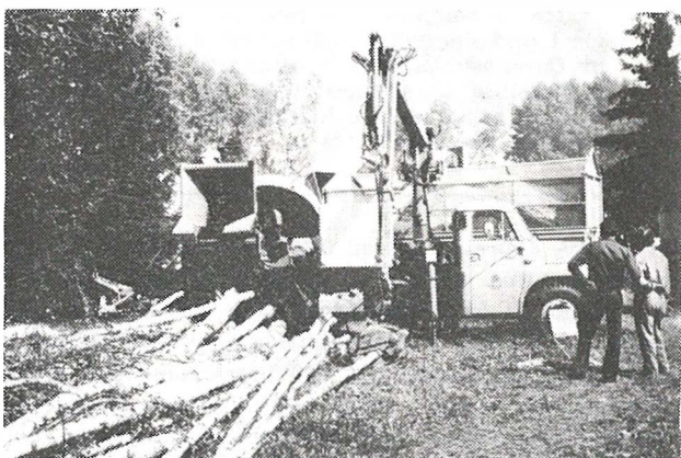
Slika 2 — Kružni iverač tip SPO na teretnom kamionu Tatra-138 (Agroslužby — Kaplice).
