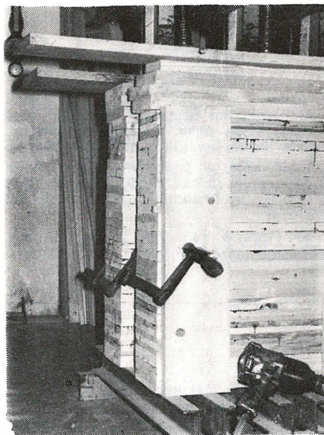
Sl. 1 — Vijčana preša s paketima lamela prema planiranim kombinacijama.
