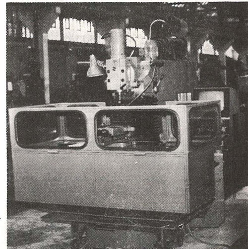
CNC — glodalica na kojoj se obrađuju dijelovi za izradu strojeva
