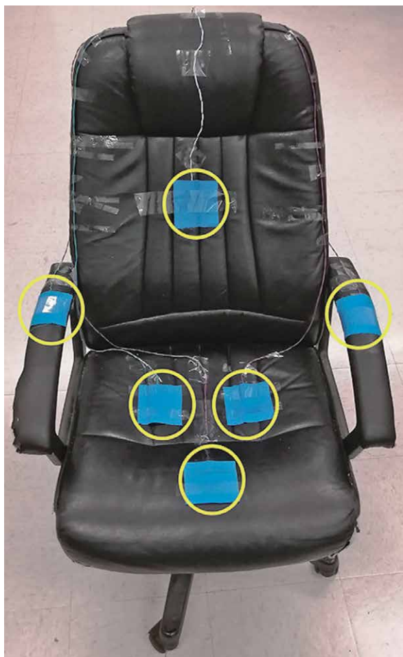
Figure 10 Flex sensor based sitting posture recognition system (Hu et al. , 2020) Slika 10. Sustav za prepoznavanje sjedećeg položaja uz pomoć senzora savijanja (Hu et al. , 2020.)
