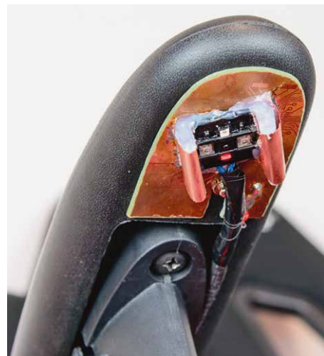
b) U-shaped ECG electrode under armrest / EKG elektroda U-oblika ispod naslona za ruke
