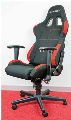
a) Unobtrusive sensors in backrest, seat, and armrests / Nenametljivi senzori u naslonu, sjedalu i naslonima za ruke
