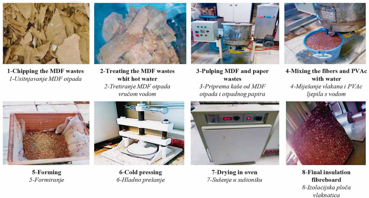
Figure 1 MDF wastes recycling and production process stages of insulation fiberboards Slika 1. Recikliranje MDF otpada i proizvodni proces izolacijskih ploča vlaknatica
