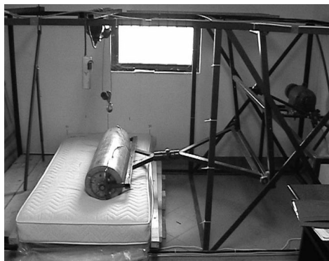
Slika 1. Uređaj za ispitivanje trajnosti (izdržljivosti) ležaja-madraca s uređajem za snimanje krivulje elastičnosti Figure 1 Equipment for testing durability of mattress with equipment for recording the load/deflection curve
