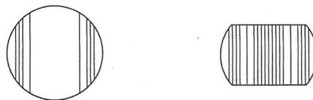
Slika 1 Piljenje prizmiranjem • Cant sawing
