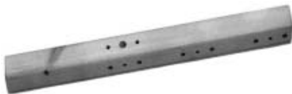
Figure 8 Examples of holes drilled in scantlings - square timber Slika 8. Primjer rupa izbušenih u četvrtacima
