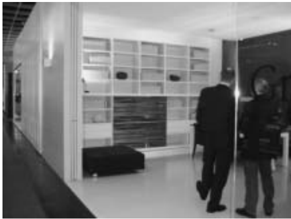
Slika 17. Ploče od vlaknatica lakirane bijelim pigmentiranim lakom visokog sjaja u kombinaciji s pločom ivericom furniranom zebrano furnirom, također lakirane prozirnim
