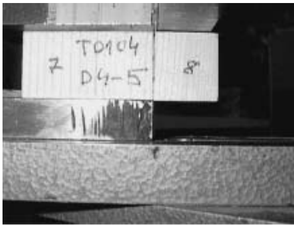
Slika 2. Ispitivanje čvrstoće na smicanja prema EN 392 Figure 2 Shear test of glue lines, EN 392
