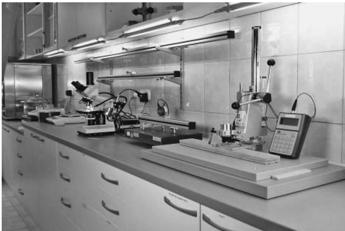
Slika 2. Sva je mjerna oprema u Laboratoriju umjerena. U prvom je planu praktičan izum Hrvoja Turkulina koji omogućuje brza mjerenja sadržaja vode elektrootpornom metodom, bez mučnoga i bučnog udaranja sondom.
