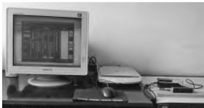
Figure 2 Surface profilometer-Mitutoyo Surftest SJ-201 used in this study Slika 2. Profilometar Mitutoyo Surftest SJ-201 upotrijebljen u istraživanju
