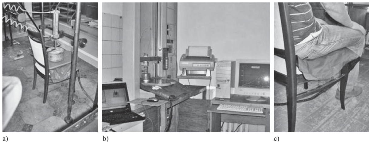
Figure 3 Stands for seat cushion stiffness tests and contact pressures on their surface: a) a special testing machine developed for furniture certification, b) ZWICK 1445 testing machine, c) volunteer weighing 74 kg Slika 3. Uzorci za testiranje krutosti sjedala i kontaktnog tlaka na površini: a) specijalni uređaj razvijen za ispitivanje namještaja prema normama, b) ZWICK 1445 uređaj za testiranje, c) ispitanik mase 74 kg
