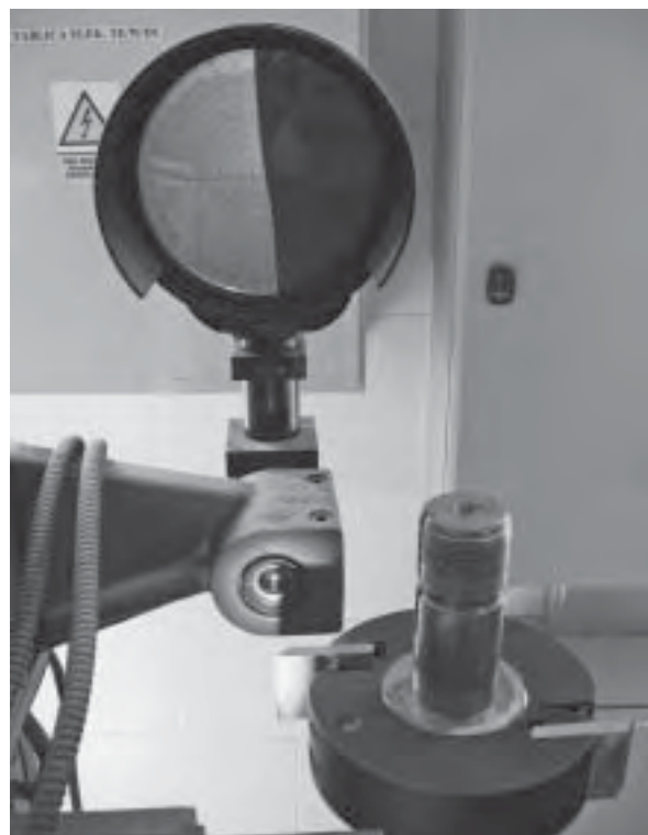
Slika 3. Upotrijebljeni nož za glodanje, glava za glodanje i sustav za mjerenje zatupljenosti oštrice alata
