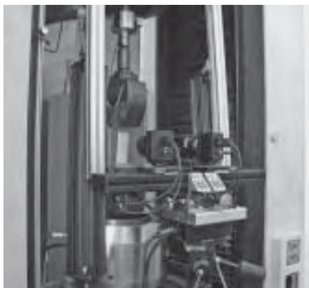
Figure 8 Optical 3D static measurement of deformations Slika 8. Optičko 3D statičko mjerenje deformacija
