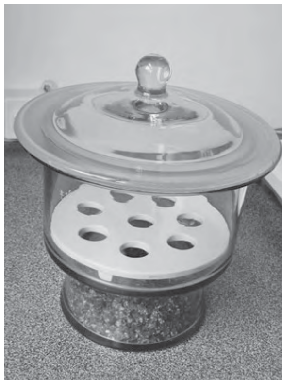
Slika 3. Stakleni eksikator bez tubusa (foto: Pervan i Klarić) Figure 3 Glass desiccator without tubus (photo: Pervan and Klarić)
