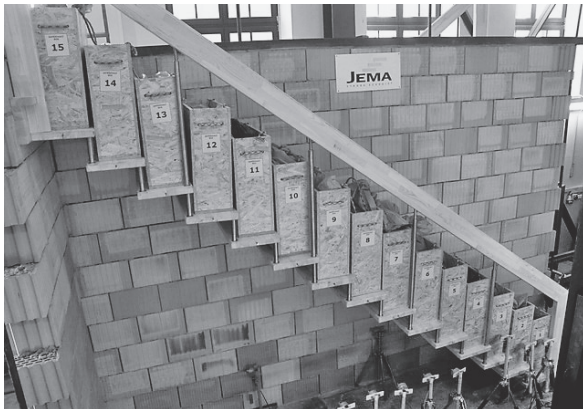
Figure 7 Prototypes of the staircase in version A during static load test - staircase loaded with uniform serviceability load ( V = 3.0 \text{ kN/m}^2 ) increased by the 0.3 multiple Slika 7. Prototip stubišta verzije A tijekom testa statičkog opterećenja – stubište je opterećeno ravnomjermim opterećenjem V = 3,0 \text{ kN/m}^2 uvećanim za 0,3 puta
