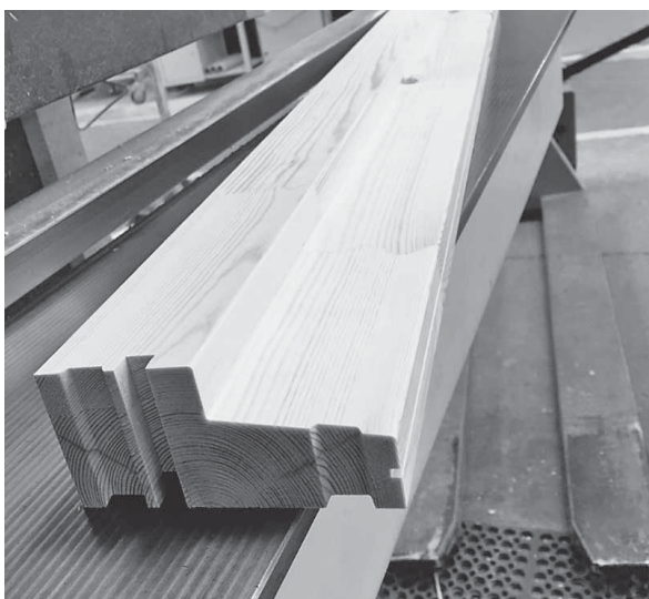
Figure 2 View of the material after machining Slika 2. Izgled drvenoga lameliranog elementa nakon strojne obrade
