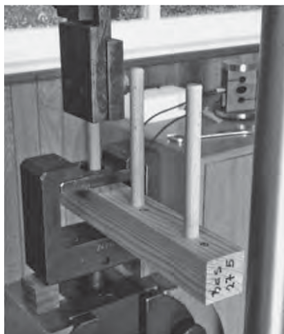
Figure 5 Manner of placing the testing specimen in the universal testing machine Slika 5. Način postavljanja ispitnih uzoraka u univerzalni stroj za ispitivanje
