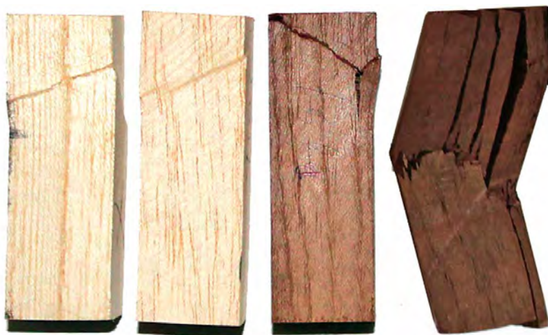
Figure 3 Specimens after the completion of compression strength test Slika 3. Uzorci nakon ispitivanja čvrstoće na tlak
