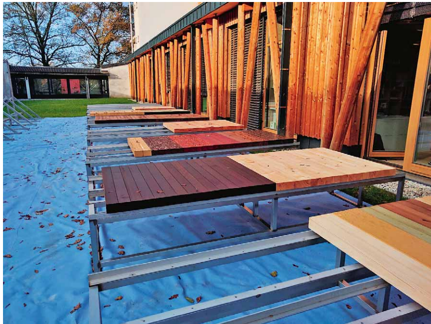
Figure 1 Glulams at the beginning of the experiment on the test field of the University of Ljubljana, Biotechnical faculty Slika 1. Lamelirani nosači na početku izlaganja na izlagalištu Biotehničkog fakulteta Sveučilišta u Ljubljani
